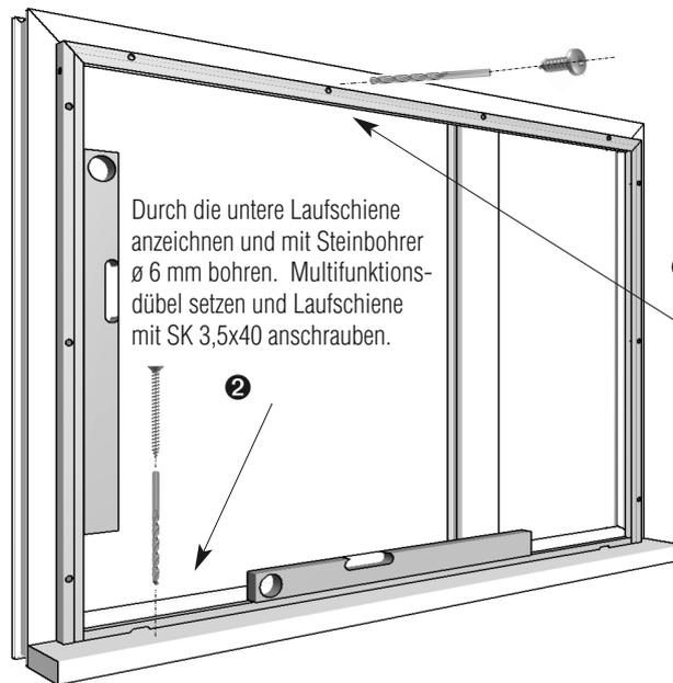
Durch die untere Laufschiene anzeichnen und mit Steinbohrer  $\varnothing$  6 mm bohren. Multifunktionsdübel setzen und Laufschiene mit SK 3,5x40 anschrauben.
