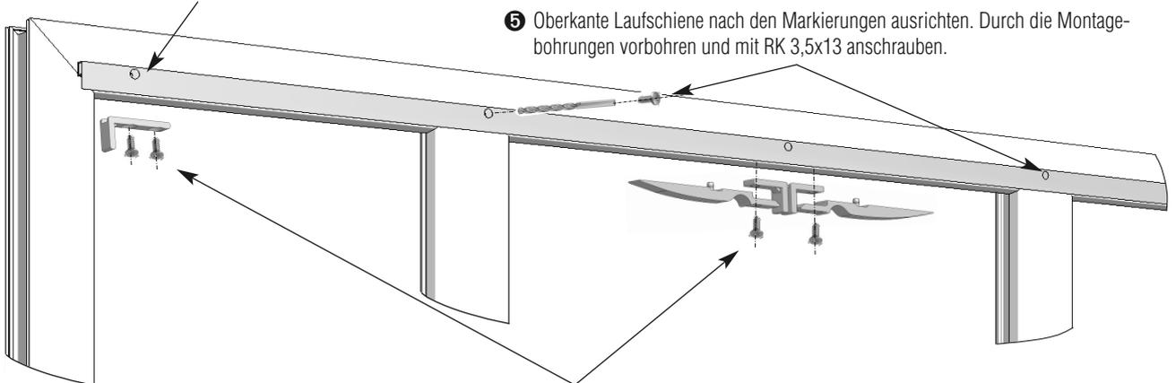
Die Bohrlehre 164850 für die Anschlagwinkel an den Markierungen der Außenkanten (Punkt 2) ansetzen und durch die ersten zwei Bohrbuchsen mit Bohrer  $\varnothing$  2,2 mm vorbohren. Danach Mittelanschlagspunkt festlegen. Mit der gleichen Bohrlehre im Abstand von je 6 mm links und rechts vom Mittelanschlagspunkt, durch die beide äußeren Bohrbuchsen, für die Mittelanschläge und Schiebeflügelarretierungen vorbohren. Mit SK 2,9x9,5 Anschlagwinkel und Aufaubremser anschrauben.
