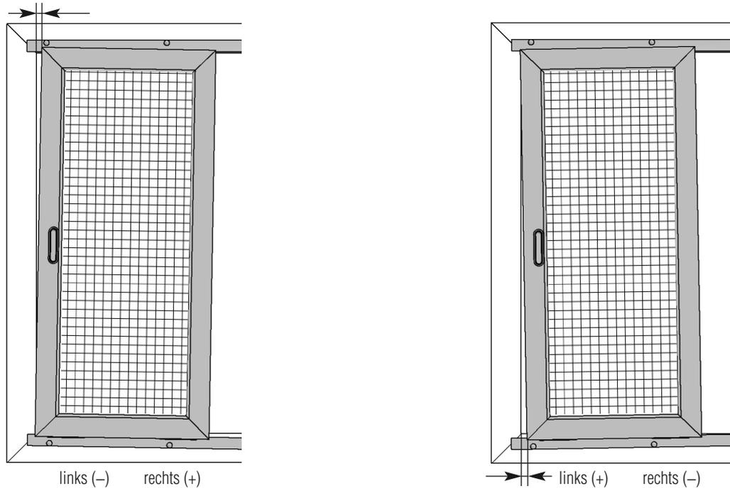
Durch Verschieben des Kunststoffrollenhalters in die ( — ) Richtung, wandert der **Schiebeflügel** auf dieser Seite um **1 mm** nach **unten**.
