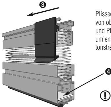
Plisseeverschlusssteil in dem Profil ohne Bürste von oben einschieben **3**, bis zur Mitte fahren und Plisseekit schließen. Die Schnur mit Schnurumlenkung und Schnurspanner mithilfe des Kartonstreifens **4** aus dem Plisseekit herausziehen.
