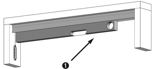
Kastenprofil waagrecht in der Leibung ausrichten ①. Bohrpositionen durch die Montagebohrungen ② anzeichnen, mit Steinbohrer  $\varnothing$  6 mm vorbohren. Mitgelieferte Dübel setzen und mit Schrauben RK 3,9 x 38 anschrauben.
