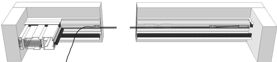
Schnur vor dem Schnurspanner mit 3-fach Schlingknoten verknoten und fest anziehen. Den Rest der Schnur anschließend ca. 3 cm nach dem Knoten abschneiden.
