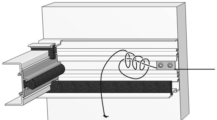
Die Schnur mit dem Schnurspanner wie bei Schritt 3 Punkt 8 beschrieben, leicht spannen und Gewindesttife anziehen.
