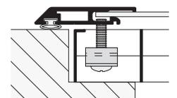
Alternativ kann die Lichtschachtabdeckung auch mit einem Butyl-Dichtband 3,0 mm mit dem Rost verklebt werden.
