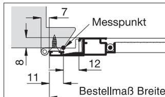
**Bei sehr schrägem Falz anderen Messpunkt verwenden:**
