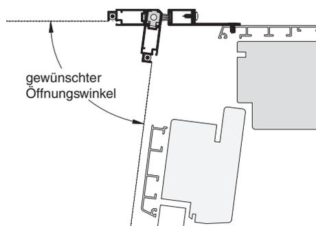
Es stehen Winkelprofile mit einer Schenkellänge von 40, 60 oder 80 mm zur Verfügung. Diese können sowohl auf der Band- als auch auf der Verschlussseite angebracht werden. Eine Anleitung zur Berechnung der passenden Winkelgröße finden Sie im Variantenfinder (siehe Neher-App).
