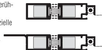
Bei extremen Windbelastungen kann die Magnetkraft durch Einhängen weiterer Blockmagnete vergrößert werden (Zusatzausstattungen, Seite 12).
