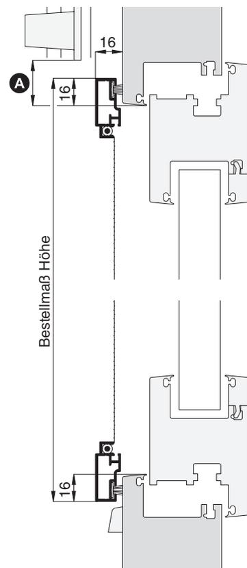
**Bei sehr schrägem Blendrahmenüberschlag (> 5 mm) anderen Messpunkt verwenden:**
