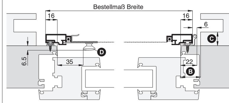
**Bei sehr schrägem Blendrahmenüberschlag (> 5 mm) anderen Messpunkt verwenden:**
